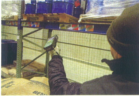
In het compartiment voor licht ontvlambare stoffen werkt Ahlers met explosie veilige barcodescanners
